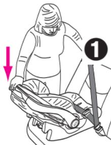
Tout en maintenant le siège de retenue ❷ ou la base ❸ près du passage de la ceinture du véhicule, TORDRE ET TIRER le siège de retenue vers l'avant et les côtés afin de s'assurer que la ceinture du véhicule ou du **SAU** ne s'étire pas et ne se relâche pas, et qu'il n'est pas facile de déplacer le siège. Le siège de retenue ne doit pas pouvoir être déplacé vers l'avant et les côtés de plus de 2,5 cm (1 po).
