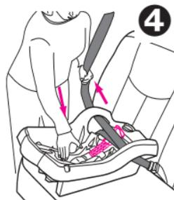
**Assurez** d'abaisser entièrement l'extrémité du dispositif de déverrouillage.
