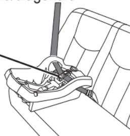
La ceinture **DOIT** passer sous le dispositif de déverrouillage
