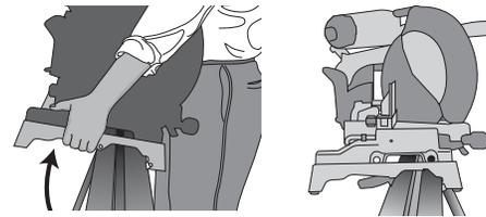
9. Approchez-vous du longeron avec le dispositif scie/ferrure légèrement incliné vers votre corps. Engagez la lèvre avant concave des ferrures sur le rebord arrondi du longeron. L'une des ferrures doit s'enclencher dans l'agrafe de positionnement (G) pour éviter tout mouvement latéral de la scie pendant son utilisation.
