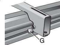
10. Cuando el borde delantero de la viga y la pinza de seguridad del localizador han sido activados, un giro ligeramente hacia abajo permite de activar las palancas traseras con la parte trasera de la viga. Mece la sierra con cuidado sobre los soportes para asegurarse que ha sido fijada correctamente.
