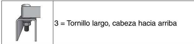
4. Una vez que el tallo de tornillo (bolsa de ferretería) ha sido instalado según la tabla del procedimiento de montaje, ensamble una arandela plana, una arandela de bloqueo y una tuerca sobre el perno. Apriete los pernos con sus dedos.
