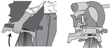
9. Acerque la viga al ensamblaje de la sierra/ pie inclinándola ligeramente hacia usted. Active el borde delantero cóncavo del soporte de montaje con el borde redondeado de la viga. Uno de los soportes debe de activar la pinza de seguridad del localizador (G) para impedir el movimiento lateral de la sierra cuando utilice la sierra.
