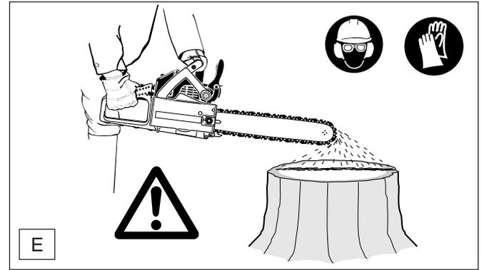
Ne jamais scier sans graissage suffisant. Vous risquez sinon de réduire la durée de vie du dispositif de sciage!
