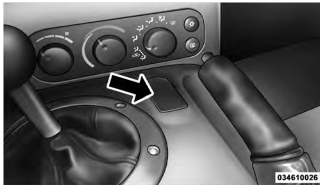
12 Volt Power Outlet
