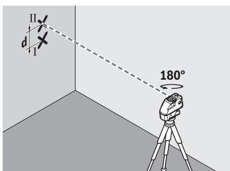
– L'écart d entre les deux points I et II marqués sur le mur indique la divergence de précision réelle de l'appareil de mesure pour la hauteur le long de l'axe transversal.
