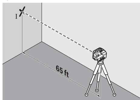
– Dirigez un des deux faisceaux laser latéraux qui courent le long de l'axe transversal de l'appareil de mesure, en direction du mur. Laissez l'appareil de mesure effectuer un niveling automatique. Marquez le milieu du point laser sur le mur (point I).
