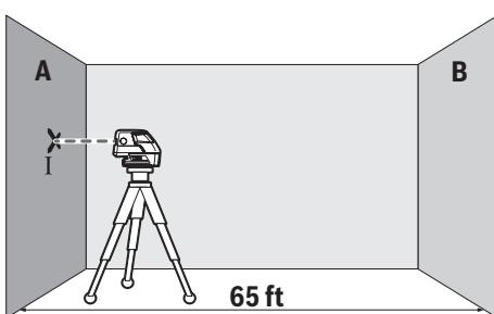
– Dirigez le faisceau laser horizontal qui est parallèle à l'axe longitudinal de l'outil de mesure vers le mur A. Laissez l'appareil de mesure effectuer un niveling automatique. Marquez le milieu du point laser sur le mur (point I).
