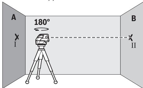
le tourner près du mur **B**, le mettre en fonctionnement et le laisser effectuer le niveling automatique.
