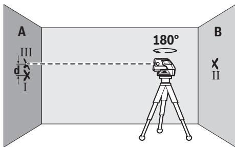
medición se nivele. Marque el centro del punto láser superior sobre la línea del techo (punto **III**).
