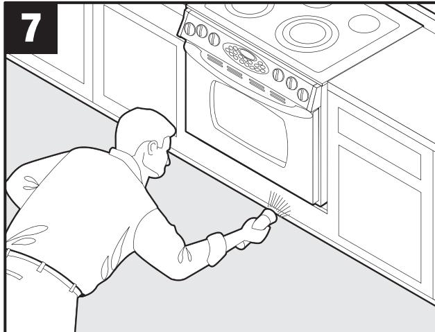
Check to make sure ANTI-TIP bracket is correctly installed on leg. Assurez-vous que la bride ANTI-BASCULEMENT est installée correctement sur le pied./Asegúrese de que el soporte ANTIVUELCO esté instalado correctamente en la pata.
