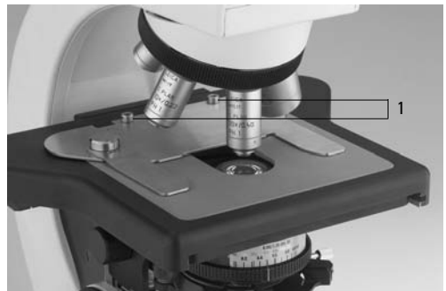
Fig. 3 Platine porte-objet avec support de préparation 1 Vis de fixation pour le support de préparation
