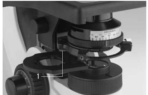
Abb. 19 Montage des Polarisatorhalters*
