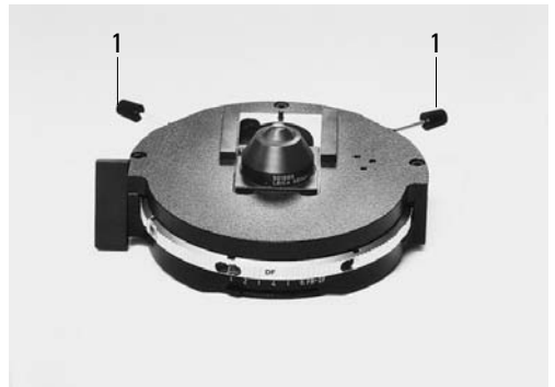
Fig. 29 Méthode de centrage du contraste de phase PH=anneau du contraste de phase, LR=anneau de lumière a Condenseur en position fond clair (BF) b Condenseur en position contraste de phase (PH) Anneau de lumière LR non centré c Anneau de lumière et anneau de phase centrés
