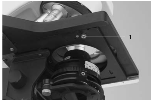
Fig. 6 Montage du levier de commande x-y de la platine
