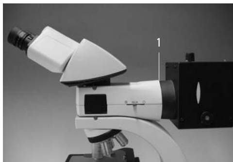
Abb. 17 Ansetzen des Lampenhaus 106z
