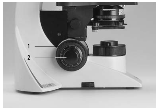
Fig. 39 Bouton de mise au point avec graduation
