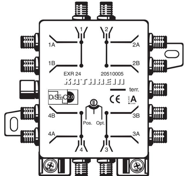
EXR 24 permet de connecter deux têtes SHF Quattro (p.ex. UAS 485) afin d'établir un système multisatellite
