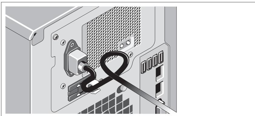
Bilden Sie mit dem System-Netzstromkabel wie abgebildet eine Schlaufe, und sichern Sie es mit dem beigefügten Riemen.
