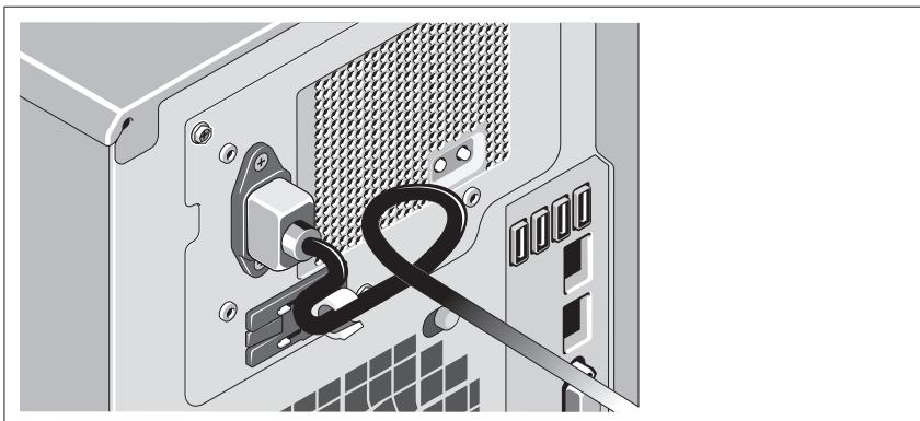
Sistemin güç kablosunu resimde gösterildiği gibi bükün ve kabloyu sistemle birlikte verilen şeridi kullanarak desteği sabitleyin.
