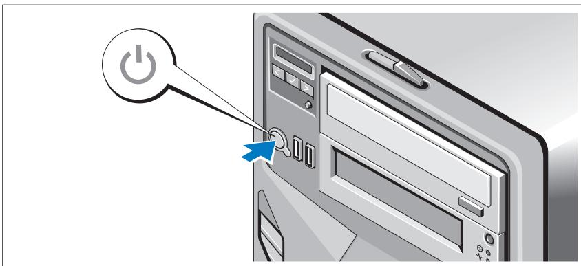
Drücken Sie den Netzschalter am System und gegebenenfalls am optionalen Bildschirm. Daraufhin sollten die Betriebsanzeigen aufleuchten.
