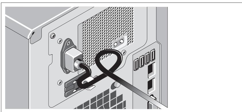
Zegnij kabel zasilania zestawu komputerowego w pętlę, w sposób przedstawiony na rysunku i zamocuj kabel, używając załączonej opaski.
