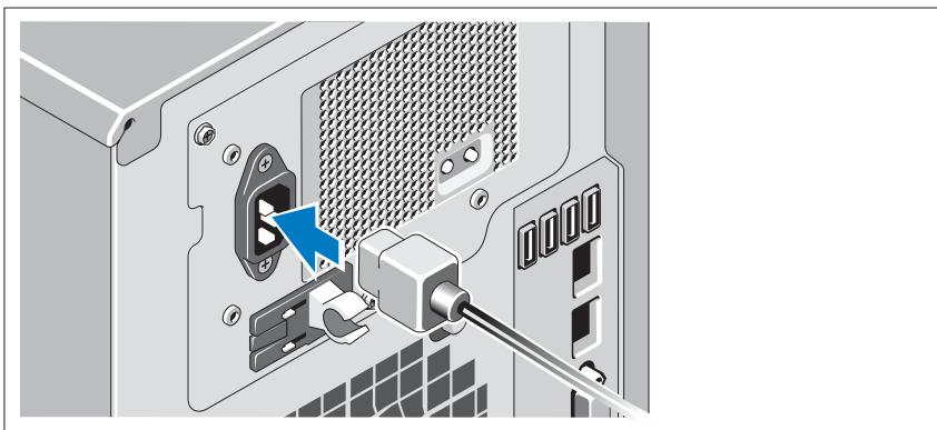
Schließen Sie das Netzstromkabel am System an. Falls ein Bildschirm verwendet wird, schließen Sie auch hier das zugehörige Netzstromkabel an.
