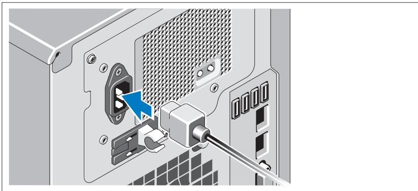
Sistemin güç kablosunun sisteme bağlantısını yapın ve bir monitör kullanılıyorsa monitörün güç kablosunun monitöre bağlantısını gerçekleştirin.
