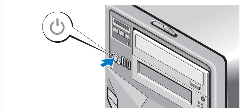
Stiskněte vypínač na systému a na volitelném monitoru (pokud je používán). Indikátory napájení by se měly rozsvítit.
