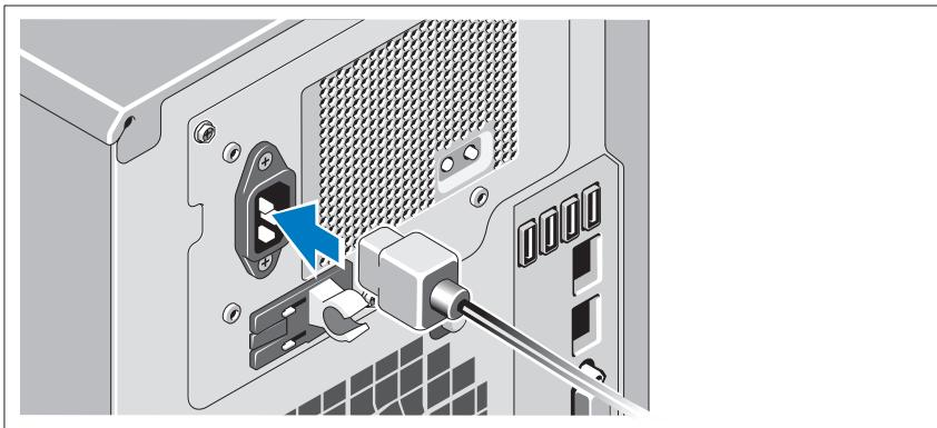
Podłącz odpowiedni kabel zasilania do komputera oraz odpowiedni kabel zasilania do monitora, o ile jest używany.
