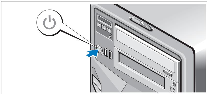
Presione el botón de encendido del sistema y del monitor opcional, si se utiliza. Los indicadores de alimentación deberían encenderse.
