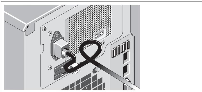
Doble el cable de alimentación del sistema en forma de bucle, como se muestra en la ilustración, y fíjelo con la correa proporcionada.
