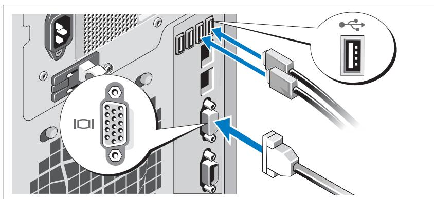
Подключите клавиатуру, мышь и монитор (дополнительно).
