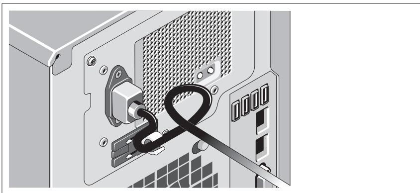
Repliez le câble d'alimentation système comme indiqué dans l'illustration suivante et fixez-le avec la bande fournie.
