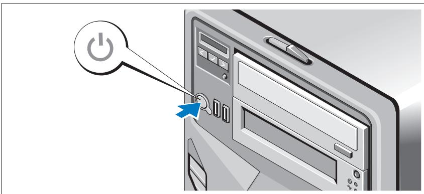
Πατήστε το κουμπί λειτουργίας στο σύστημα και στην προαιρετική οθόνη, αν χρησιμοποιείται. Ανάβουν οι λυχνίες λειτουργίας.
