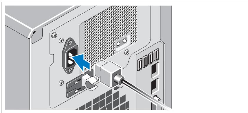
Připojte napájecí kabel k systému, a pokud používáte monitor, připojte napájecí kabel také k monitoru.
