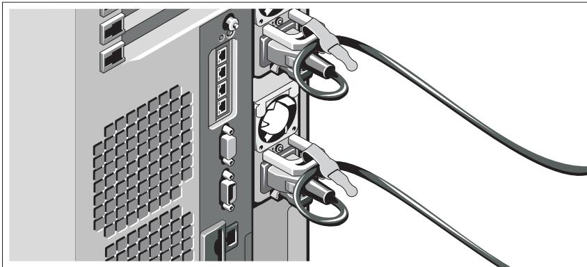
Κάμψτε το καλώδιο (ή τα καλώδια) τροφοδοσίας του συστήματος σε μορφή βρόχου, όπως φαίνεται στο σχήμα, και χρησιμοποιήστε το συνοδευτικό λουρί για να στερεώσετε το καλώδιο στο βραχίονα.
